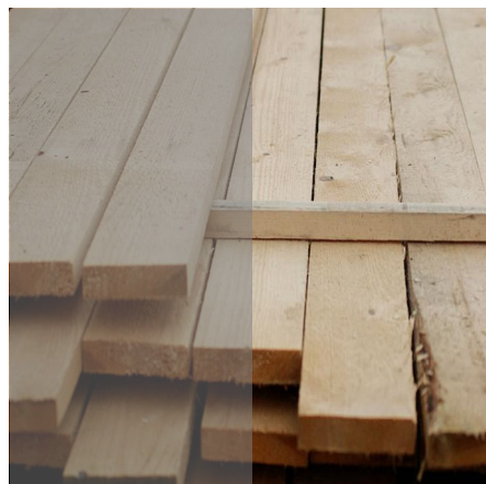
prkenný záklop - nehoblovaná prkna různé šířky, smrk, olejová lazura se světle šedým pigmentem
