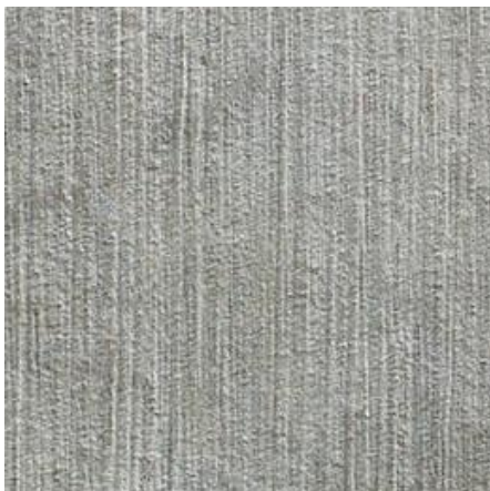
striážený beton - zdrsnění povrchu pomocí ocelového kartáče
