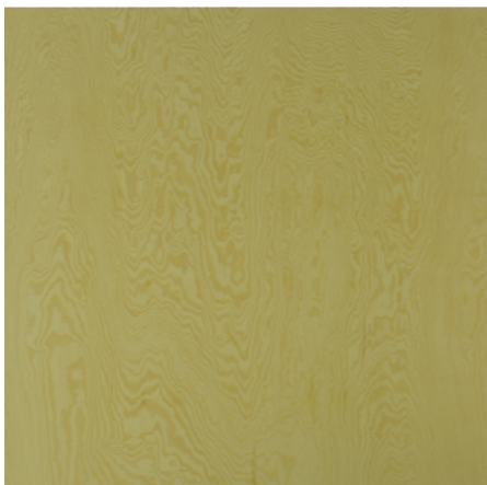
truhlářská překližka borovice, olejová lazura v odstínu RAL 6013
