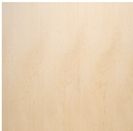
obklad ostění oken - truhlářská překližka bříza, bezbarvý lak s UV filtrem
